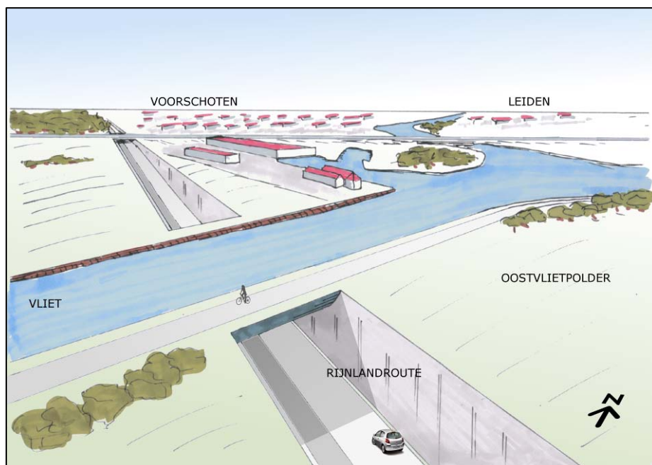
Figuur 20: open tunnelbak
